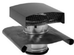
Chapeaux de toiture en acier résistants aux intempéries avec protection contre les oiseaux, pour l'amenée et l'extraction d'air dans les systèmes de ventilation, à finition noire et garniture d'étanchéité au plomb raccord tubulaire en acier galvanisé à installer sur des toitures inclinées et reliés à des tubes circulaires.
